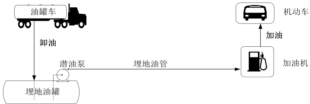
F 图 1.2-2 柴油卸油、加油工艺流程图
