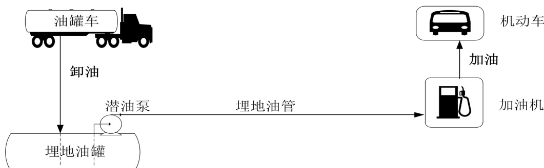
图 2.6-2 柴油卸油/加油工艺流程框图
