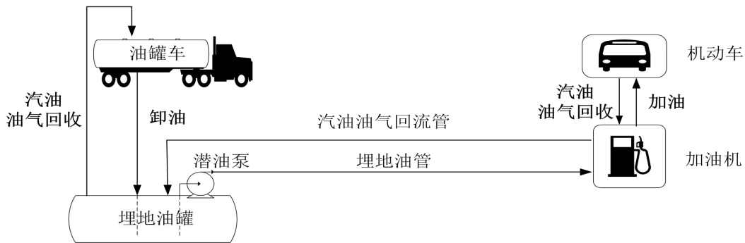
F 图 1.2-1 汽油卸油、加油及油气回收工艺流程图
