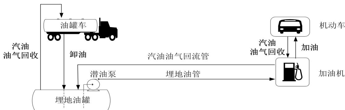
图 2.6-1 汽油卸油/加油工艺流程框图
