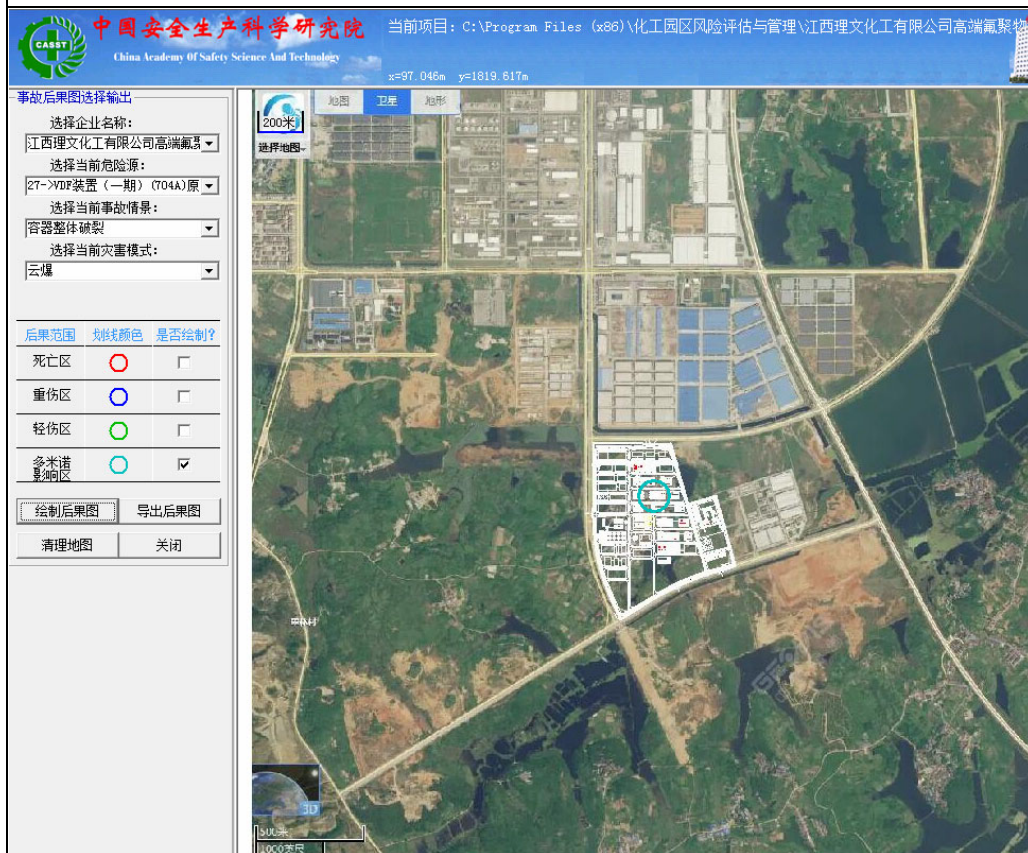
VDF 装置（一期）（704A）原料计量槽 R142b 容器整体破裂产生的云爆
