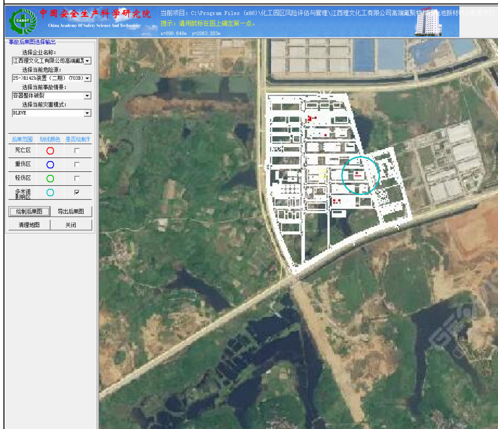
F142b 装置（二期）(703B)中间检测槽（R142b）整体破裂发生 BLEVE
