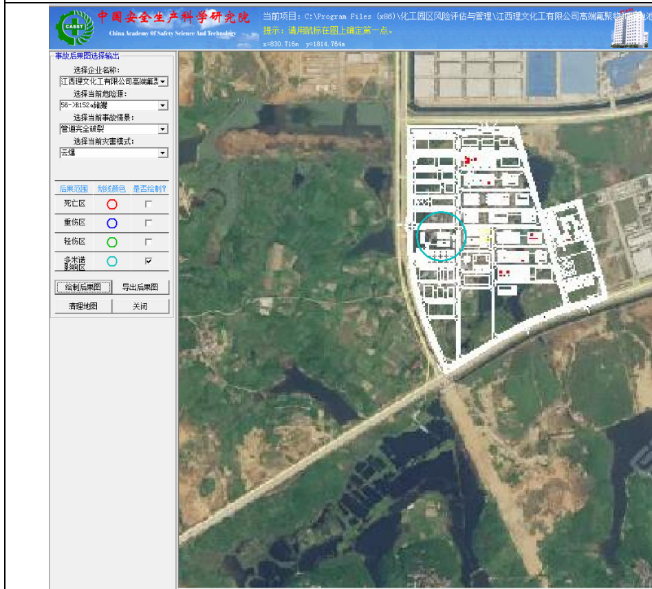
R152a 储罐管道完全破裂产生的云爆
