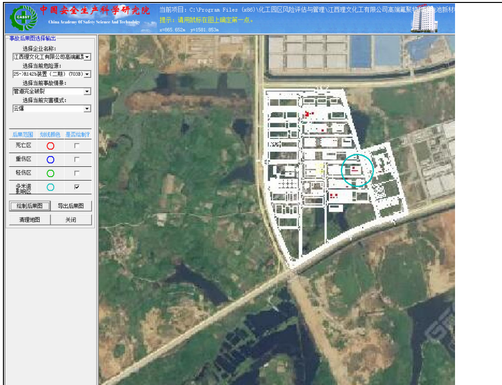
F142b 装置（二期）（703B）中间检测槽（R142b）管道完全破裂产生的云爆
