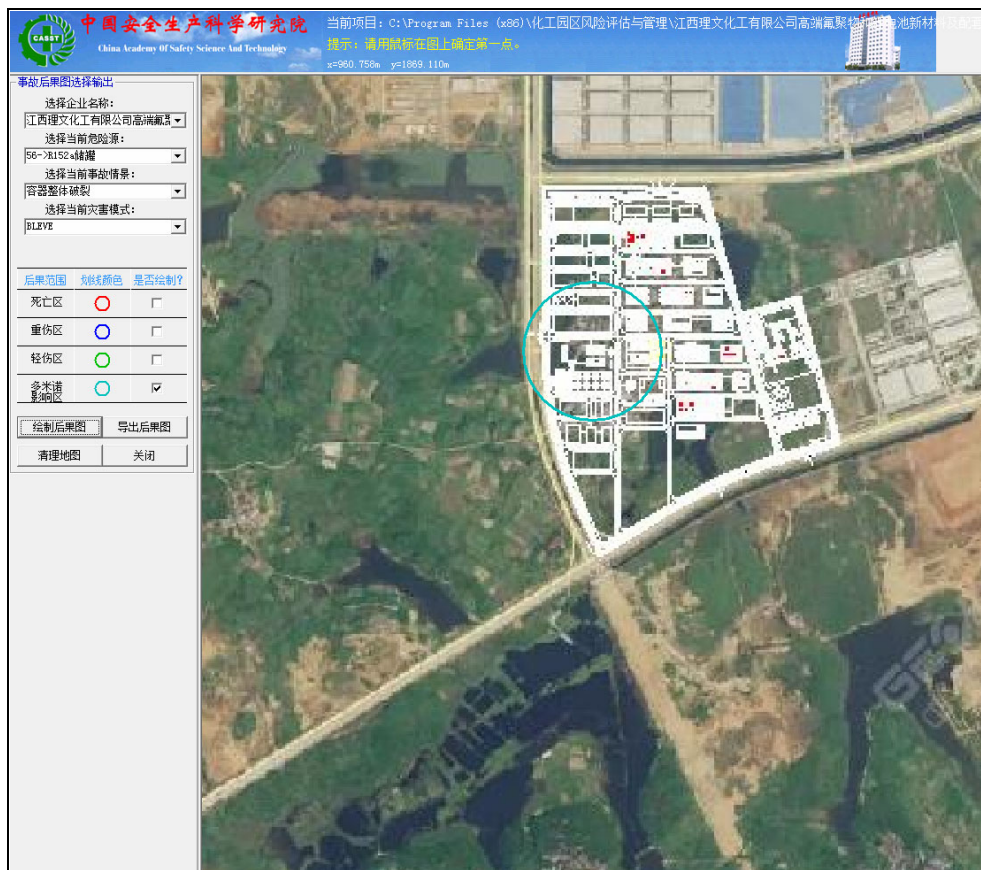
R152a 储罐整体破裂发生 BLEVE
