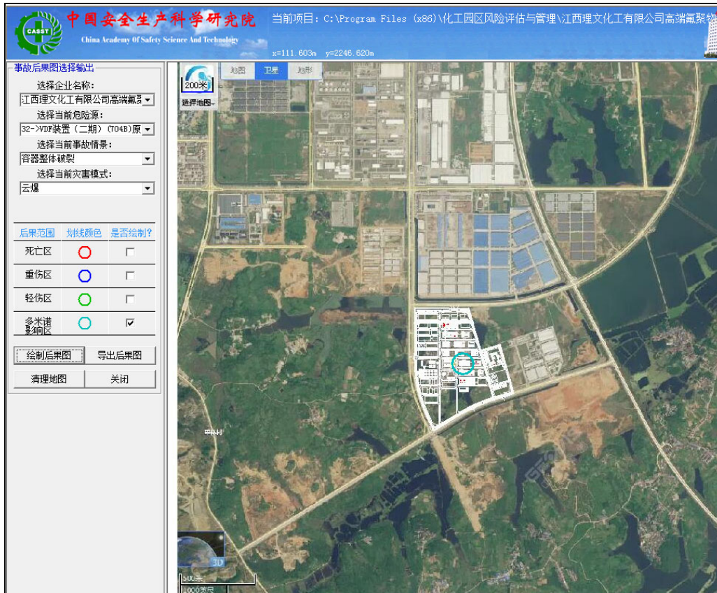
VDF 装置（二期）(704B)原料计量槽 R142b 容器整体破裂产生的云爆
