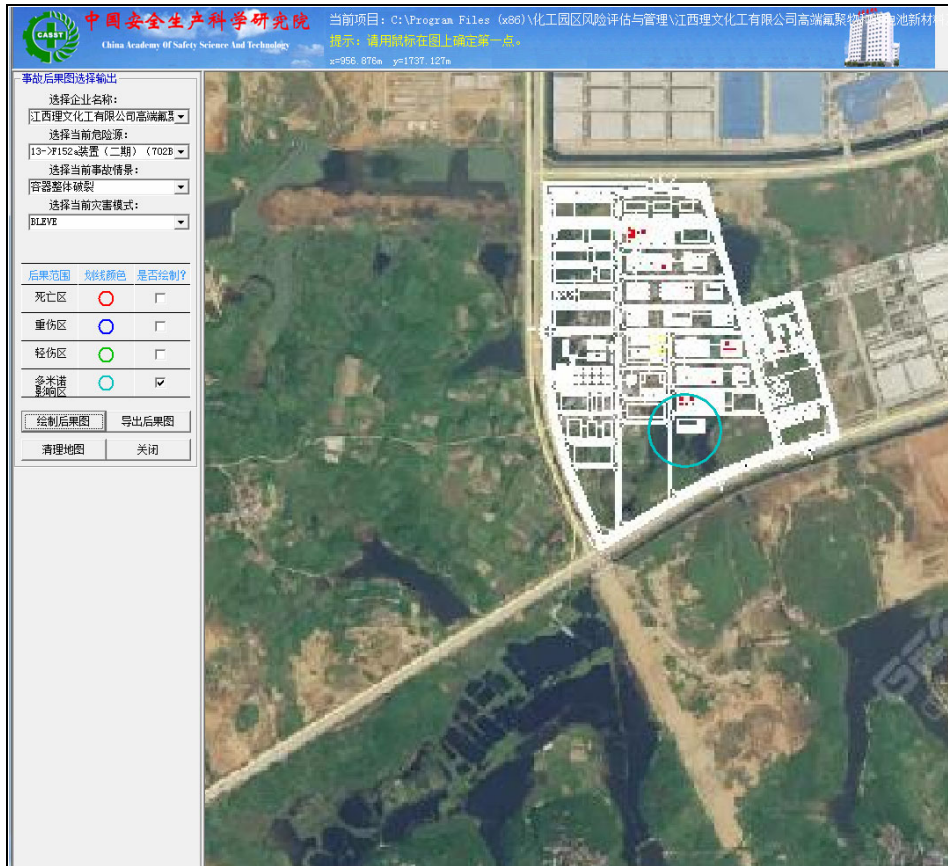
F152a 装置（二期）（702B）R152a 检测槽整体破裂发生 BLEVE
