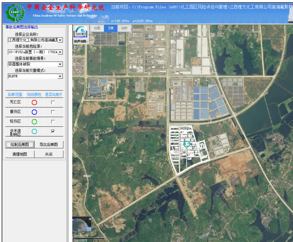
F152a 装置（一期）（702A）VCM 计量槽容器整体破裂产生的 BLEVE
