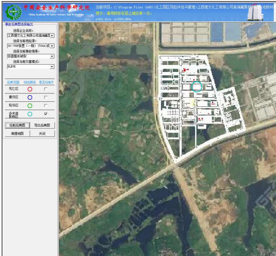
VDF 装置（一期）(704A)成品计量槽 VDF(15M3)整体破裂产生的 BLEVE
