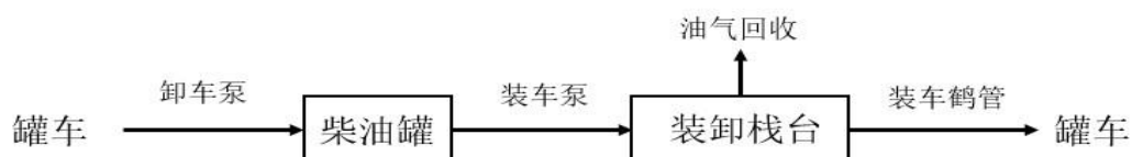
图 2-1 本项目柴油储罐上下游关系
