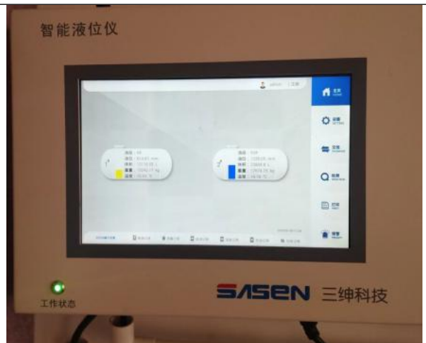
图 2-22 储罐防渗漏液位报警仪
